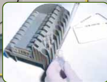
Placer les tubes inoculés sur la cassette.
